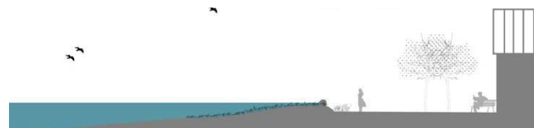
dige med "water tube" - ved høj vandstand
